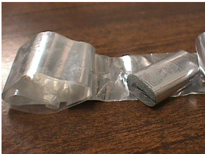
a) Construcción de un condensador
