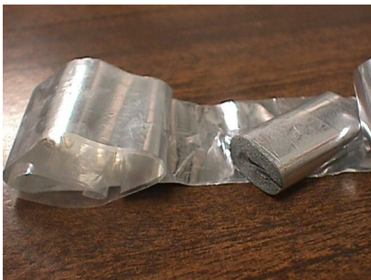
a) Construcción de un condensador
